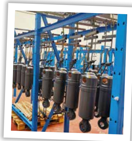
■ Nové regály na dosušovanie nastriekaných hydraulických valcov
